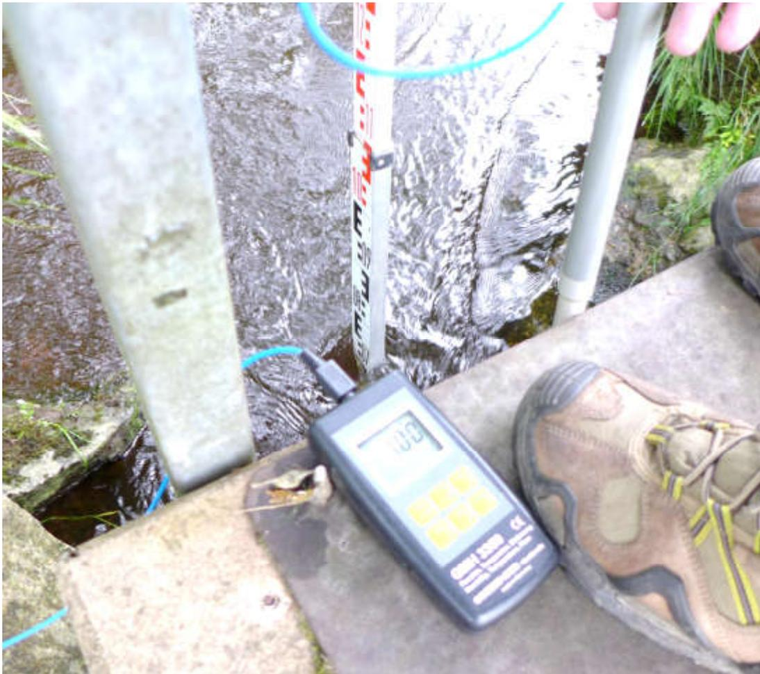
Geschwindigkeitsmessung am Dotationszulauf zur FAH/Hammerschmiede Grafenau zum OT
